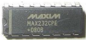
RS-232 规定使用 ttl 电平，电平在 **+5 至+15 伏特** 表示逻辑 0，电平在 **-5 至-15 伏特** 表示逻辑 1
