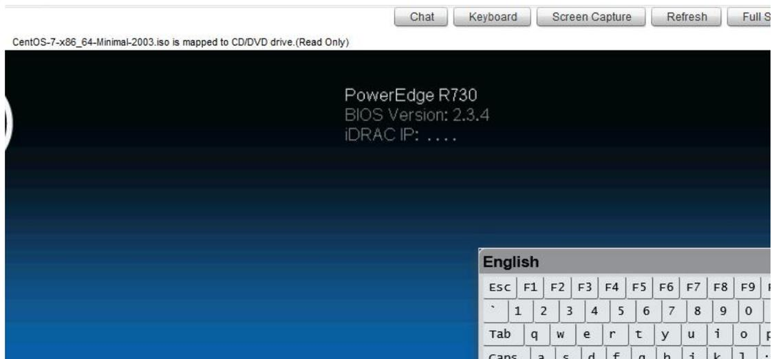
当服务器重启时，远程卡管理界面不会断开，我们在 web console 里还能看到重启的全过程，可操作 bios 设置界面，在目标服务器重启时，使用屏幕键盘按下 **F2** 进行启动项设置
