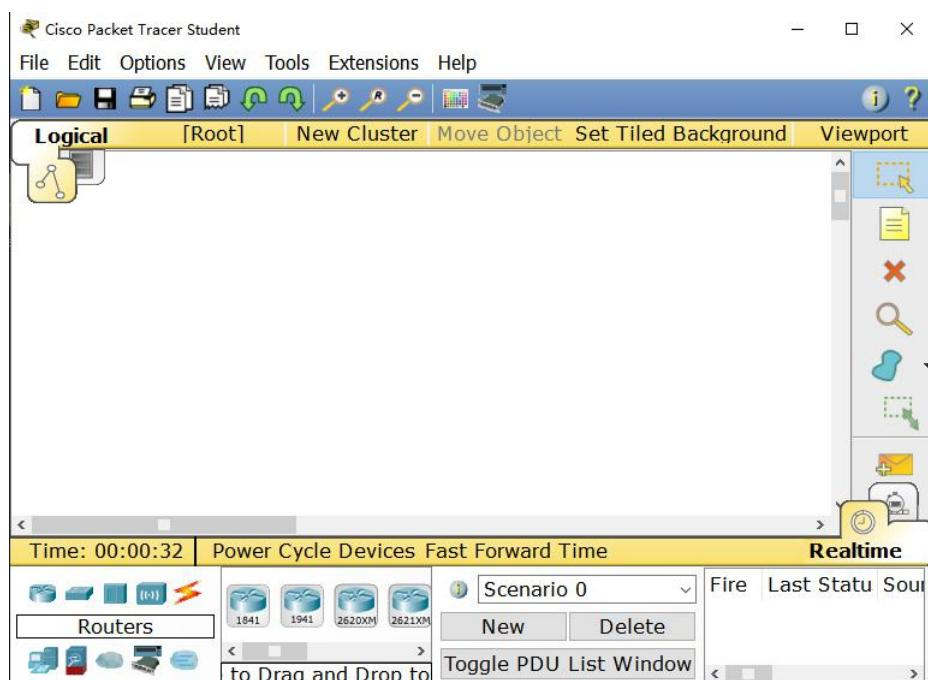
点击左下角的设备图标，拖入设备到主工作区，双击主工作区的图标即可进入命令行配置界面。
