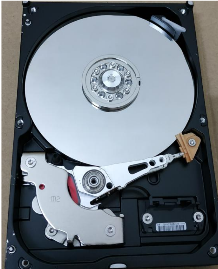
主要部分为一个金属盘片，左下部分为磁头及磁头控制部分，
