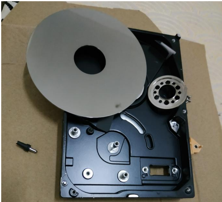
主要部分为一个金属盘片，左下部分为磁头及磁头控制部分，
